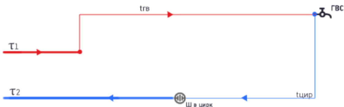
Рисунок 1.11 – Схема присоединения теплотребляющих установок (система отопления) потребителей к тепловым сетям
