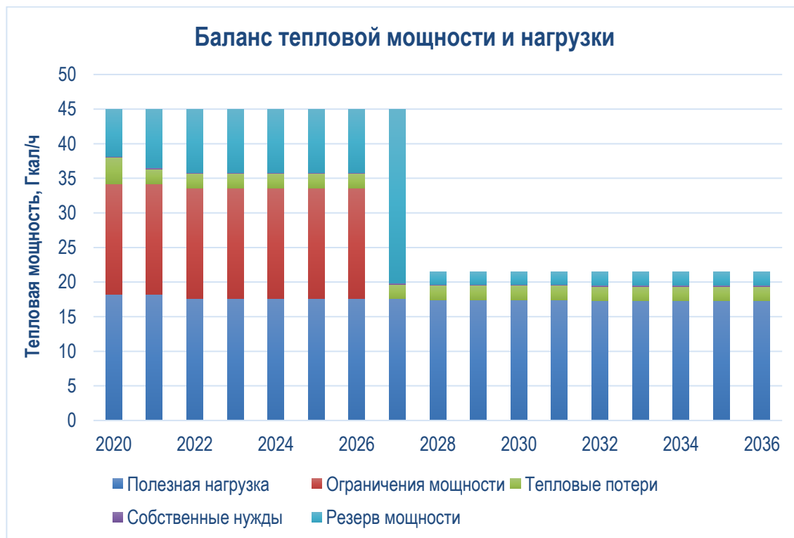
Рисунок 5.1 – Прогнозный баланс тепловой мощности и тепловой нагрузки
